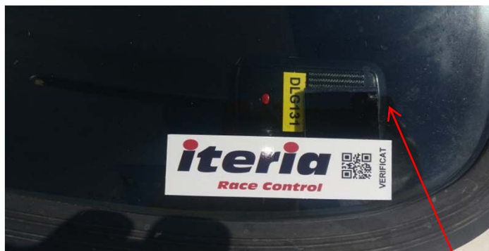
VELCRO I DETALL COL.LOCACIÓ A PARABRISSES
